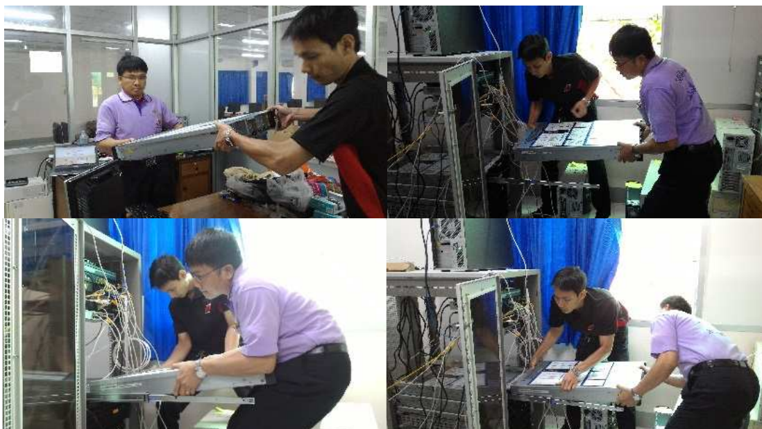
ภาพที่ 4.21 การประกอบเครื่องแม่ข่ายเข้าสู่ตู้บรรจุเครื่องแม่ข่าย
